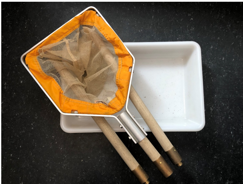
Fig. 4: Vandkjetsjer til undersøgelse af presence-absence af lampretlarver.
